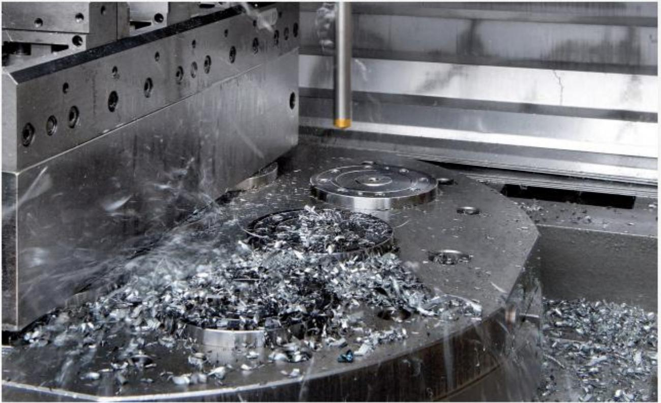
AMF自动除屑刀柄：自动清理夹具和机床工作台
