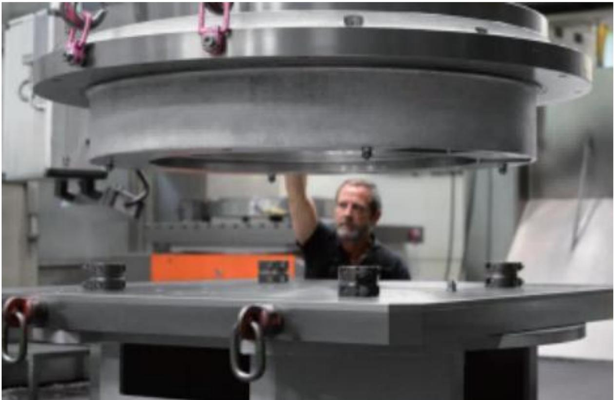
双头零点定位单元可以被用来快速调节间距，从而使小批量多品种零件的装夹更快速，更简单。
