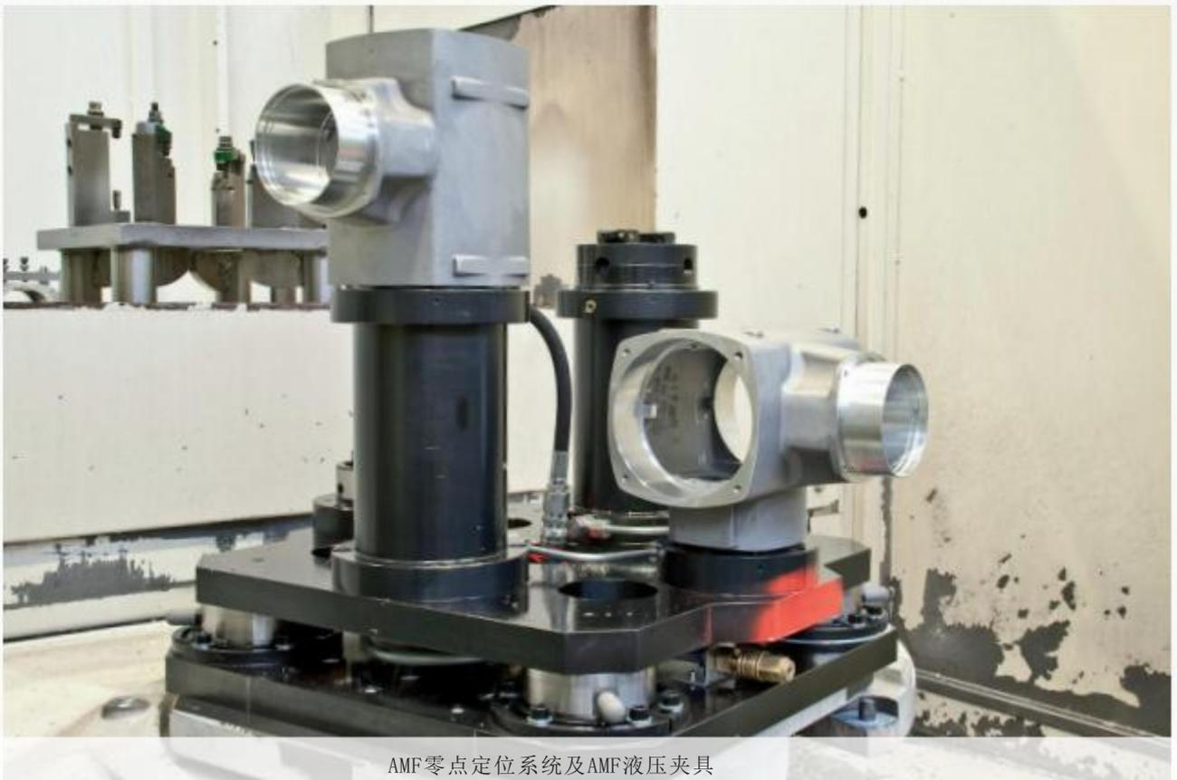
AMF零点定位系统及AMF液压夹具
