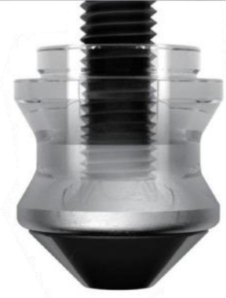
> 零点定位系统中的定位销是机床台面与工件或者夹具的连接接触界面。它保证了精确的定位和可靠的夹紧。产生的作用力通过定位销传递给零点定位器。
