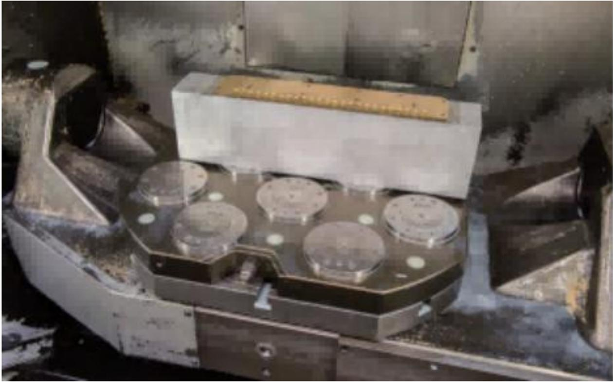
AMF零点定位系统用于模具装夹
