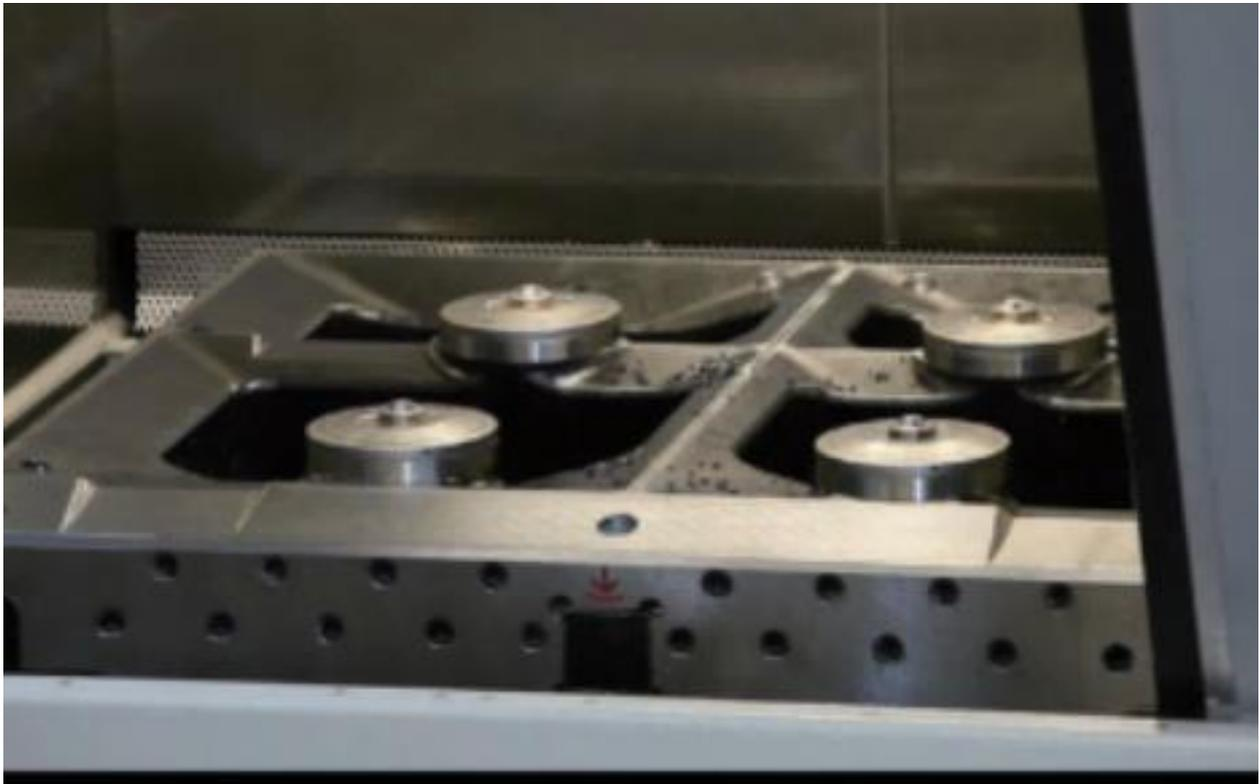
全自动化涡轮吹屑型零点定位工作台
