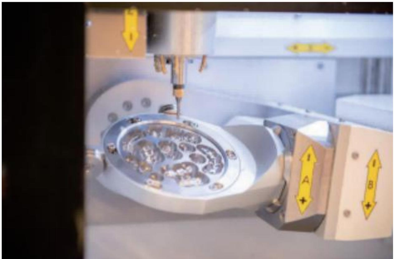
加工钛合金牙齿的全自动生产线
